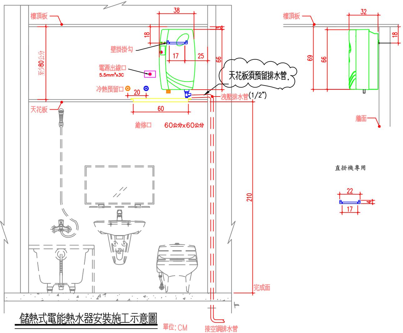
儲熱式電能熱水器安裝施工示意圖
